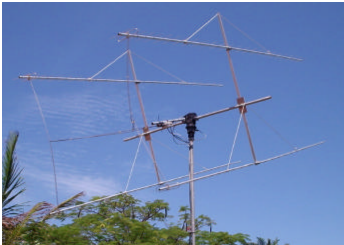
FY5DG's 4 x 26 el BV Yagis Array for 70 cm
