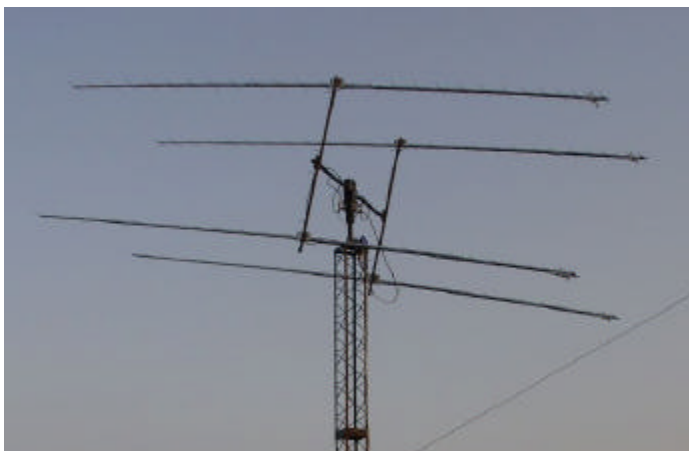
UT5CJW's 4 x 28 el M2 9 wl yagi array on 70 cm EME
